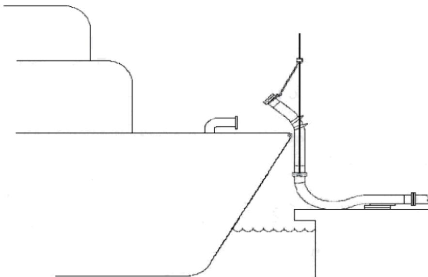
Figura 1 – içamento e transporte de linha de mangotes
