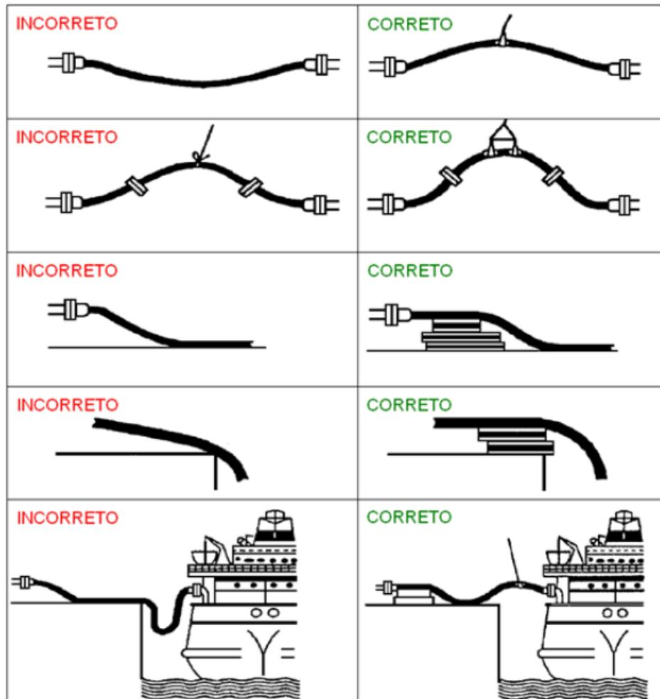
Figura 02 - Posicionamento dos Mangotes
