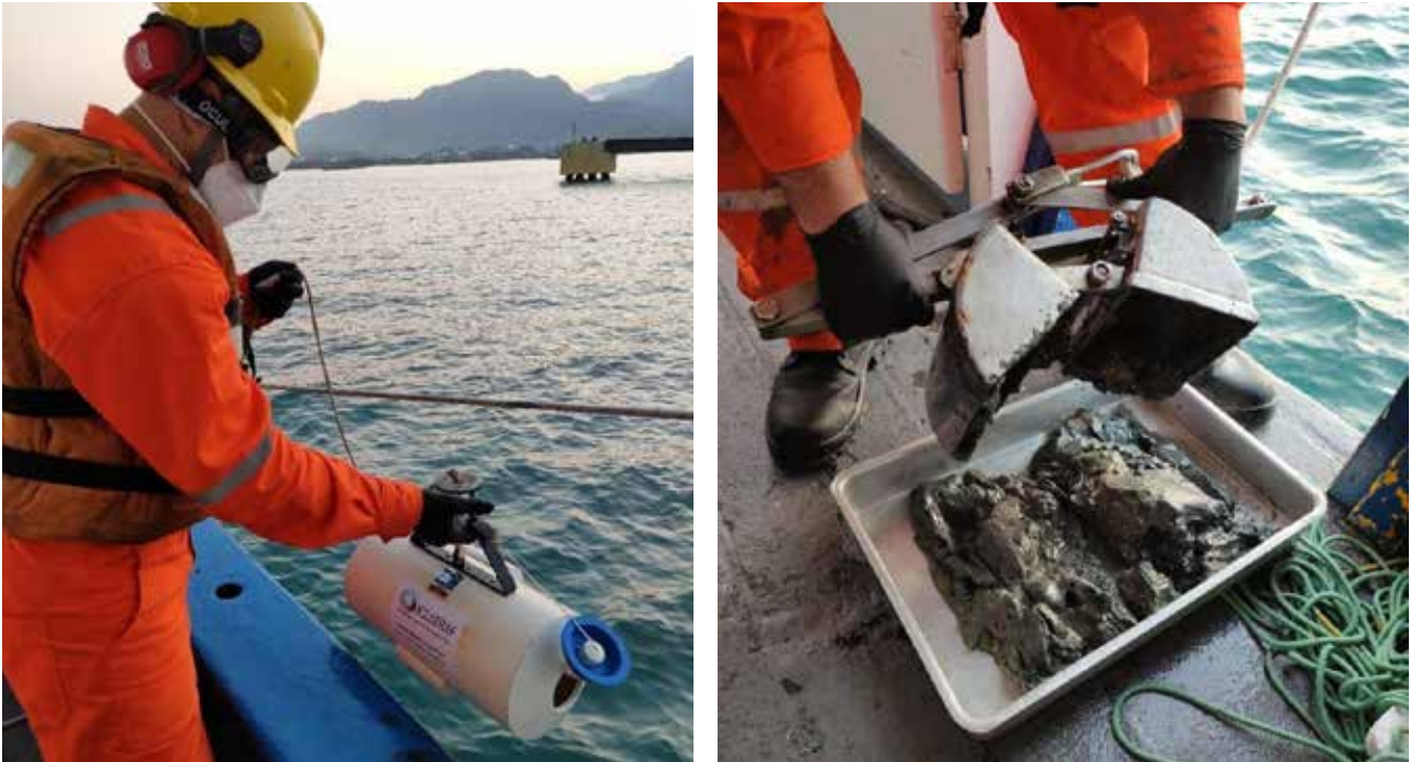
FIGURA 5: Coleta de amostras para análise de qualidade da água, biota e sedimento marinhos durante o monitoramento semestral do Canal de São Sebastião.
