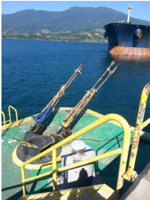
Figura 12 Cabos de aço de 42mm com calabrotos empregados no TEBAR para amarrar uma embarcação do tipo VLCC.
