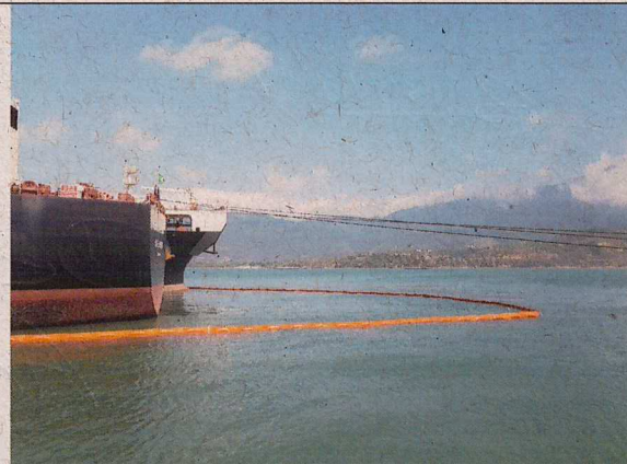
Cerco ao sul do Pier 1, a favor da correnteza
