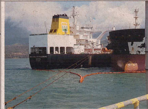
Cerco ao norte, a favor da correnteza, preso com cabos
