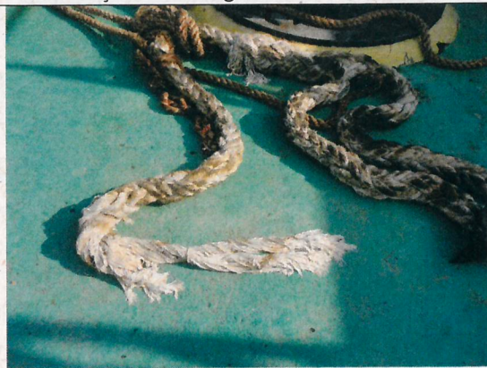
Cabos rompidos em todos os pontos de amarração
