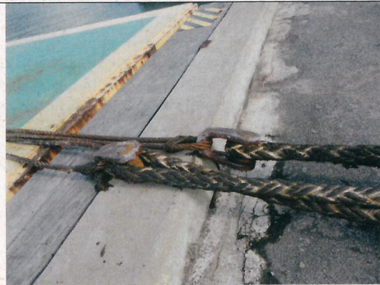
Junção dos cabos de aço à parte com trançado sintético (nylon)
