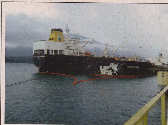
Navios atracados a contra bordo, com presença de barreira de contenção instalada
