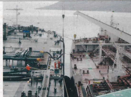
Uso de guindastes para movimentação de mangotes
