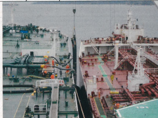
Mangotes com cabeçote amarelo de balanço de gases VOCs e movimentação do mangote de transferência de produto
