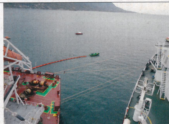
Procedimento de instalação de barreiras na popa
