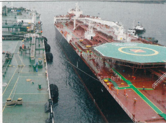
Aproximação com uso de rebocadores e cabos de amarração sendo passados
