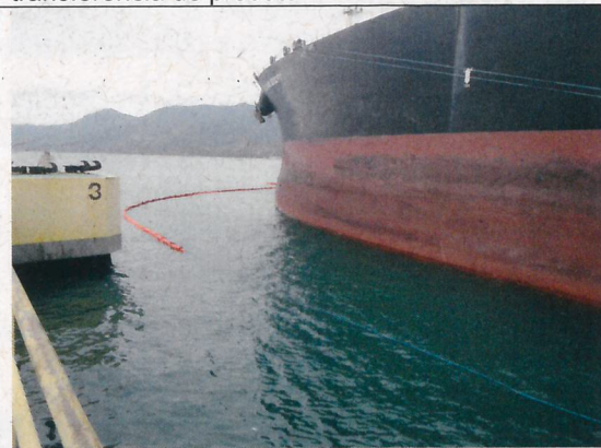
Procedimento de instalação de barreiras na proa
