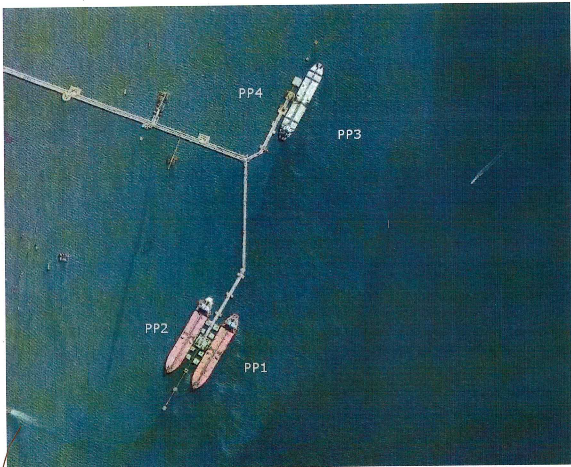
Figura 1 TEBIG (área de estudo) com uma embarcação tipo VLCC atracada no berço externo e outra do tipo Suezmax no berço interno
